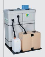
经过这个初步处理去除了大片浮油及大颗粒油滴,然后冷凝液流入预过滤器,预过滤器具有对油的凝聚作用,会使悬浮在液体中的微小油滴凝聚成大油滴,浮在上面。经过预过滤的冷凝液进入活性炭过滤器吸附少量的残余油和微量乳化液。
