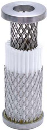
为提高燃点和减少电荷的聚集，氧气滤芯取消了针毡材质的凝液层。
