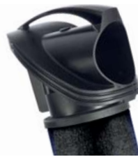
独特的滤芯 新型滤芯端盖设计增大了流量、减小了压差
